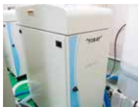
限外濾過フィルターユニット
